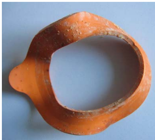
Joint de bocal, charge ocre, moisissures
