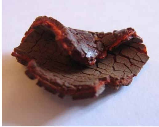
Courroie, charge ocre rouge, craquelures profondes et non orientées
